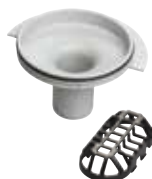
verticaal model, zonder sifon, met zeefinzetstuk, afvoercapaciteit stuwhoogte 10 mm 1,2 l/s, afvoercapaciteit stuwhoogte 20 mm 1,2 l/s Model 4982.83
