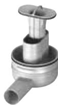
voor bouwhoogten vanaf 95 mm, Afvoercapaciteit: 0,5 - 0,55 l/s*, Waterslotheogte: 50 mm (inkortbaar volgens renovatiemodel) Model 4982.92
